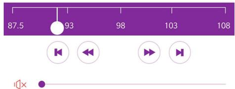
Drücken Sie und , um manuell eine Frequenz in Schritten von 0.05 MHz einzustellen. Nutzen Sie diese Tasten, um eine bekannte Frequenz genau einzustellen.
