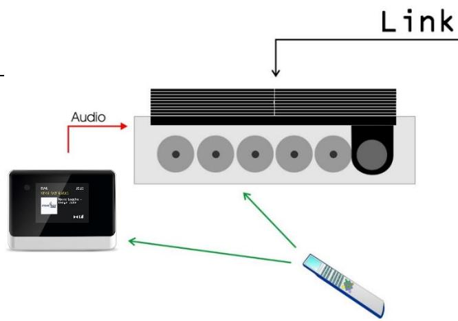
Er der på B&O systemet ingen indgang, der åbner ved tryk på kilden **AMEM** eller **ATAPE**, skal DabFmBlue5 tilsluttes til en anden indgang, og DabFmBlue5 skal derfor programmeres i overensstemmelse hermed.
